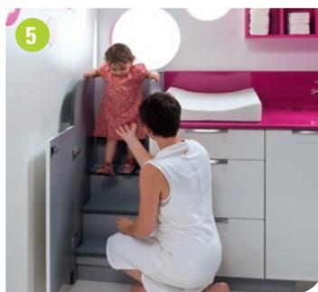
Coussants (4) (avec système de blocage en position ouverte) ou fixes (5) les escaliers permettent aux enfants d'accéder en toute sécurité au plan de change et évitent les efforts répétés des éducatrices. Une porte dissimule le système quand il n'est pas utilisé.
